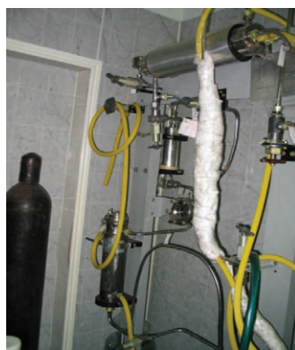
Рис. 5. Фазовая диаграмма диоксида углерода с указанием области состояния «сверхкритическая жидкость» (А), установка для обработки биосырья диоксидом углерода в состоянии сверхкритической жидкости (Б).
